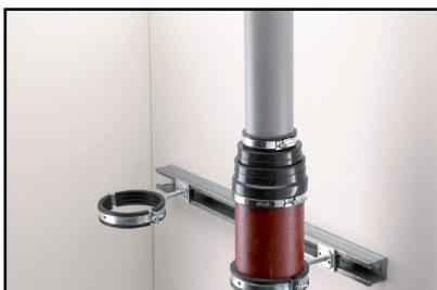
3. Označte připojovací trubku v hloubce zasunutí, namažte ji, zatlačte a upevněte pomocí dalších hadicových svorek.
