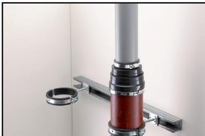
3. Marque el tubo de conexión a la profundidad de inserción, aplique lubricante y empújelo y fíjelo con las otras abrazaderas de manguera.
